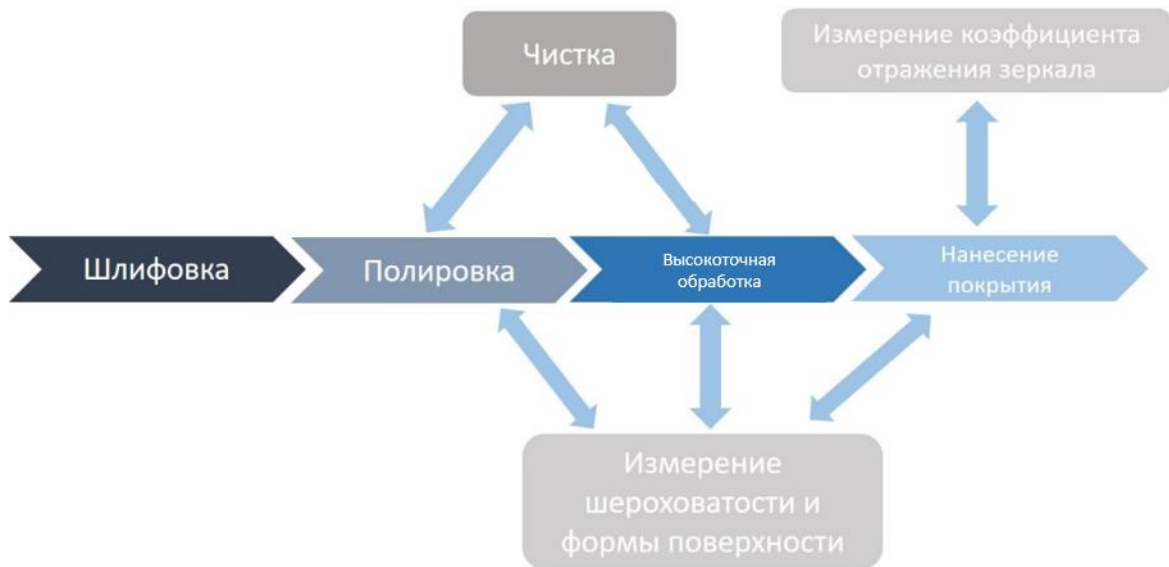
Рисунок 1.1. Схема процесса формирования высокоточной рентгенооптической поверхности от шлифовки исходной заготовки до нанесения многослойного рентгеновского зеркала
