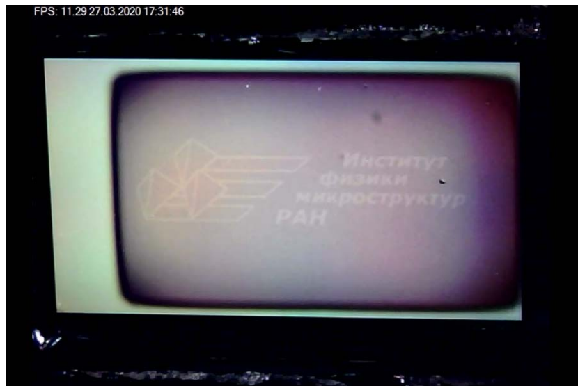
Рисунок 4.13 – Фрагмент видео, демонстрирующее работоспособность МЭМС с ALD пассивирующим покрытием и МРЗ C/Si, отражающим 13,5 нм после облучения в течение 40 часов излучением с длиной волны в окрестности 13.5 нм и плотностью мощности 0.21 Вт/см 2 .
