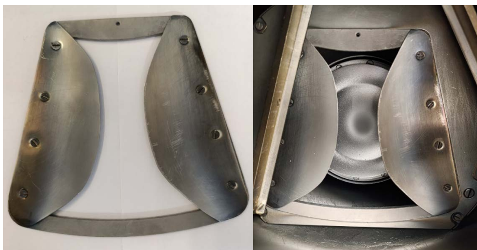
Рисунок 1.3 – фотографии характерной фигурной диафрагмы (слева) и ее расположение в камере установки магнетронного осаждения над распыляемой мишенью (справа).
