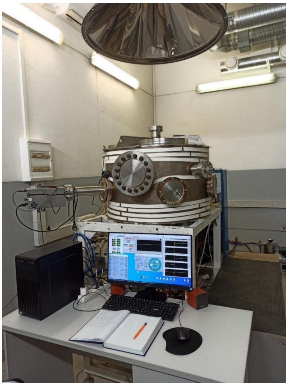
Рис. 1.1 – Фото установки магнетронного осаждения в специализированной бериллиевой лаборатории ИФМ РАН.
