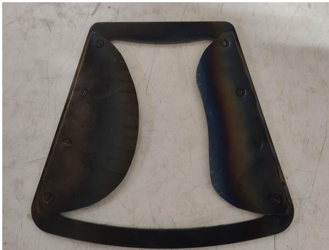
Рисунок 1.5 – Пример фигурной диафрагмы, задающий равномерное распределение распыляемого вещества на подложке
