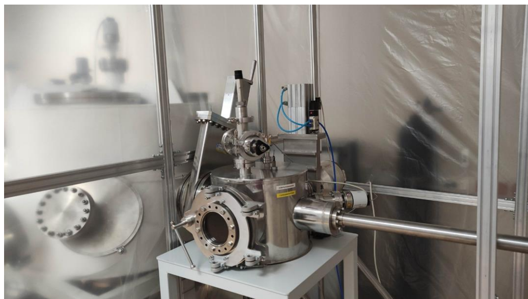
Рисунок 1.8 – Вакуумный шлюз с затвором, отсекающим шлюзовую камеру от основного вакуумного объема, в котором происходит синтез зеркал.
