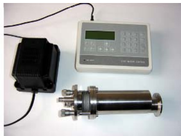
Рис. 8. Рентгенооптическая схема и фотография измерителя ЭУФ мощности с блоком питания и контроллером управления.
