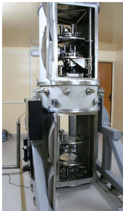
Рис. 9. Фотография и оптическая схемы интерферометра для аттестации объективов: 1– лазер, 2 – линза, 3 – источники сферической волны, 4 –делитель пучка, 5 – CCD камера, M1 и M2 – исследуемый объектив, 6 – PC.
