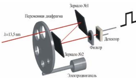
Рис. 8. Рентгенооптическая схема и фотография измерителя ЭУФ мощности с блоком питания и контроллером управления.
