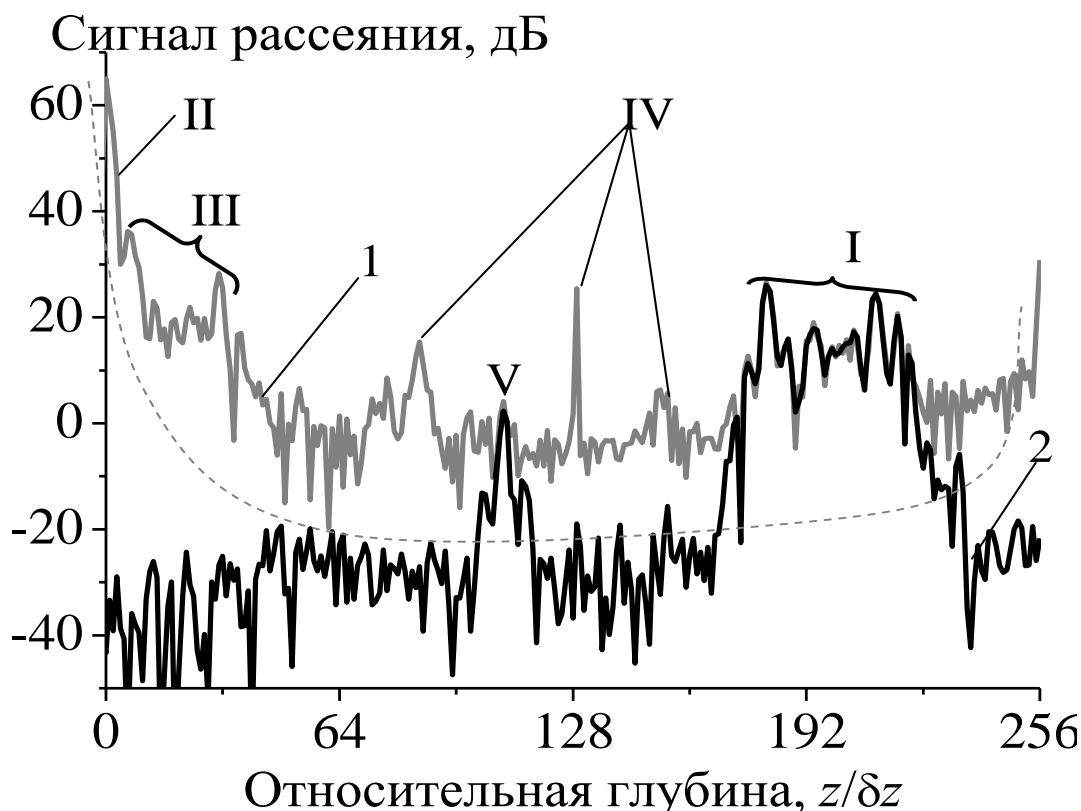
Рис. 25. Профиль рассеяния от тонкой полимерной пленки до компенсации когерентных помех – 1 и после компенсации – 2. Положение исследуемого объекта – область I; автокорреляционная компонента – II; когерентные помехи, обусловленные интерференцией между отдельными рассеянными компонентами – III, паразитные отражения в оптическом тракте системы – IV; отражение от выходного окна сканера – V.
