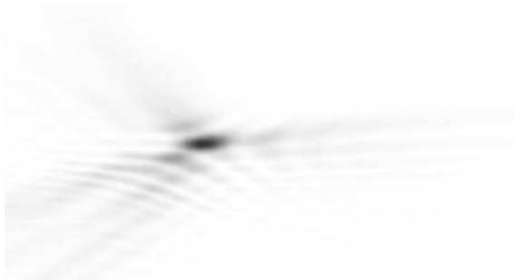
Рис. 26. Изображение лазерного пучка на ПЗС-камере
