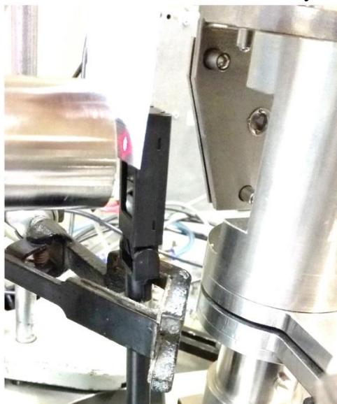
Рис. 6. Совмещение луча с датчиком мощности в крепеже
