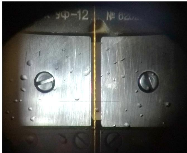
Рис. 12. Проверка вертикальности Щ 2
