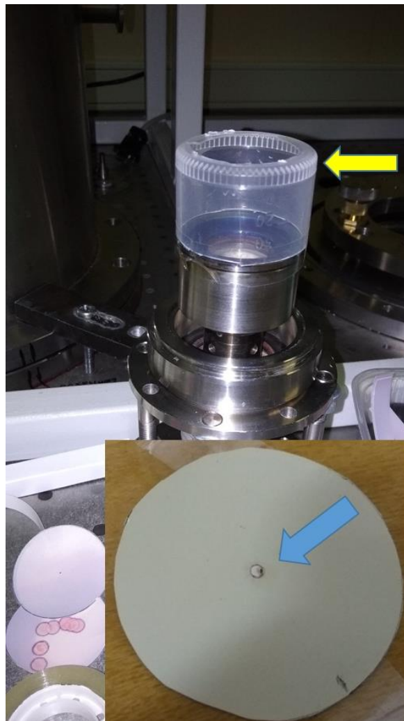
Рис. 32. Настройка положения линзы
