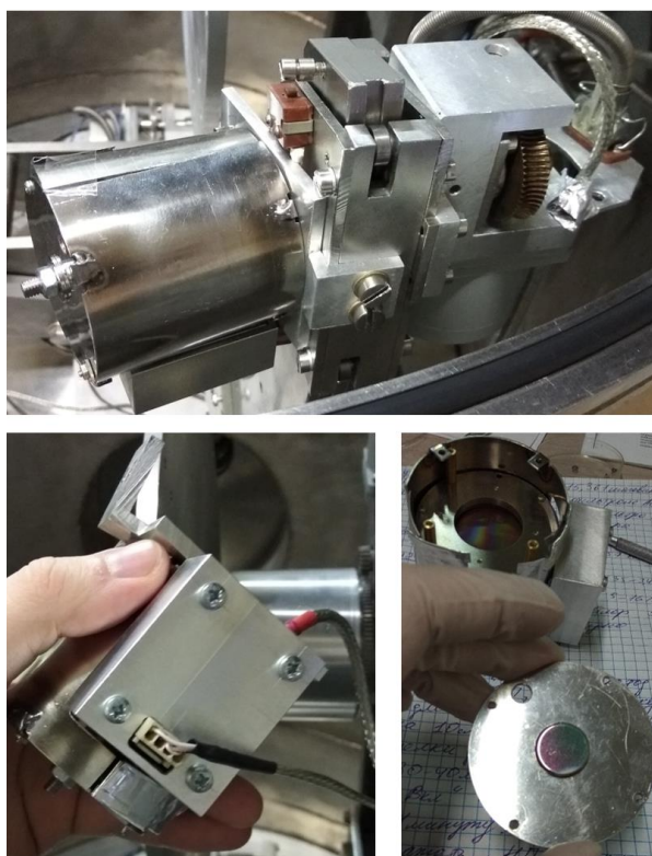
Рисунок 3.17. Детектор на шевронной сборке из двух микроканальных пластин (МКП) с фотокатодом CsI.
