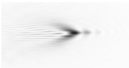
Рис. 25. Изображение на ПЗС-камере при плохой юстировке ТЗ
