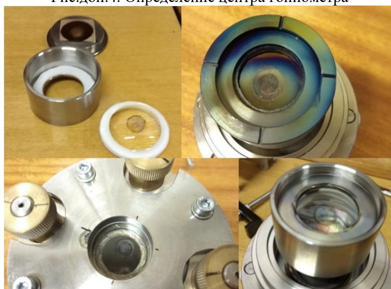
Рис.доп.5. Плановое обслуживание оптического ввода
