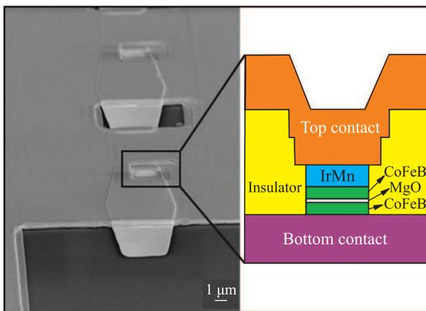
Рис. 1. (Цветной онлайн) Изображение участка цепочки TMR-контактов, полученное в растровом электронном микроскопе (слева) и схематическое изображение сечения (перпендикулярного цепочке) TMR-контакта (справа)
