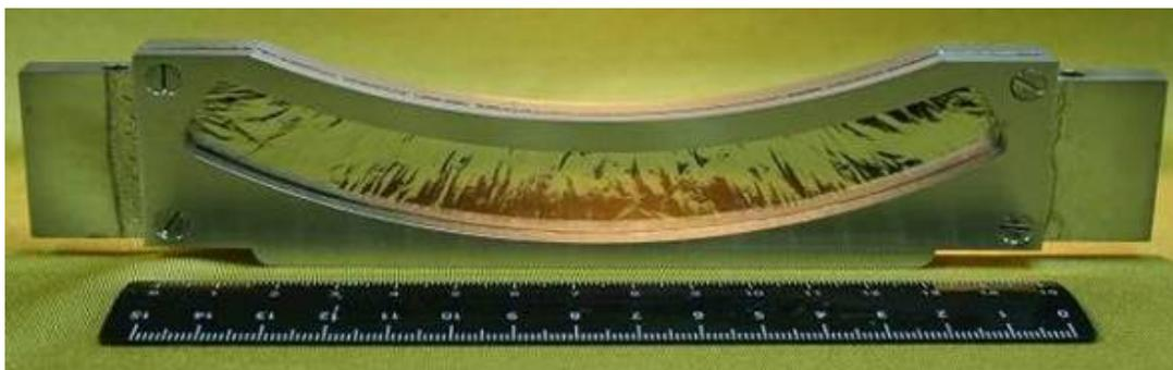
*Первый спектральный фильтр на основе Zr/Si (с размерами  $140 \times 20$  мм<sup>2</sup> при толщине 53 нм), разработанный специально для сканера ADM компании ASML. Фильтр сохранял долговременную работоспособность при поглощенной мощности излучения до  $\approx 1$  Вт/см<sup>2</sup>.*
