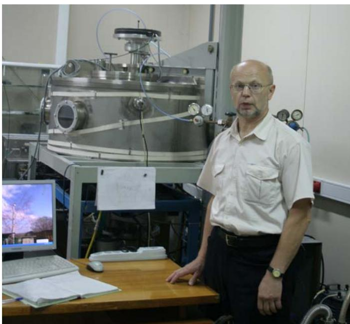
*Технологическая установка с шестью магнетронами для нанесения многослойных структур.*
